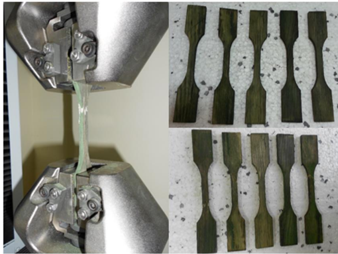
Şekil 2. CCB nano Parçacık emprenye edilmiş paralel çekme deney düzeneği ve numuneleri
