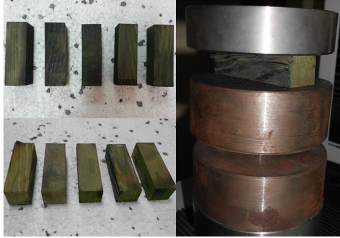
Şekil 5. CCB nano Parçacık emprenye edilmiş dik basınç deney düzeneği ve numuneleri
