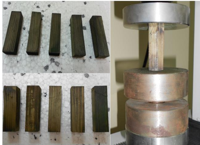
Şekil 4. CCB nano Parçacık emprenye edilmiş paralel basınç deney düzeneği ve numuneleri
