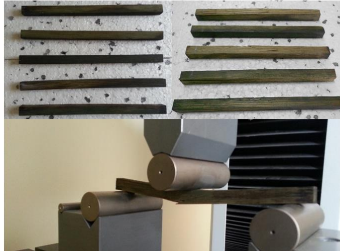
Şekil 6. CCB nano Parçacık emprenye edilmiş üç nokta eğilme deney düzeneği ve numuneleri
